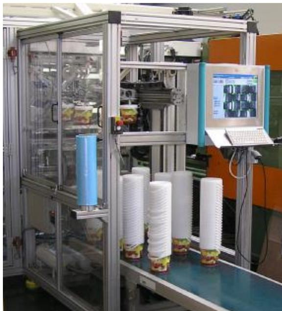
QMTSort-IML integriert in Entnahmehandling
