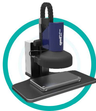
Mesure de la précision des montres - Marches diurnes
