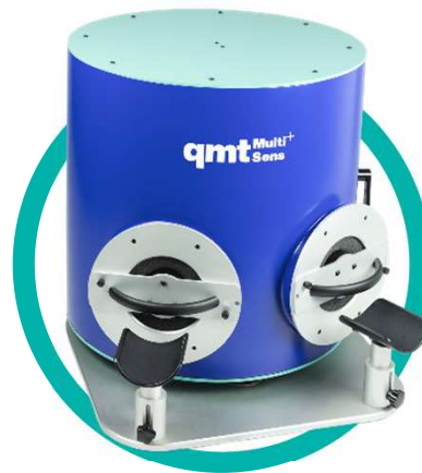
Contrôle optique et acoustique des montres à sonnerie
