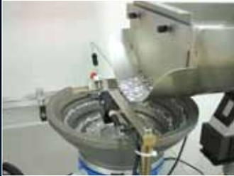
Automatische Teilezuführung mit Wendelförderer
