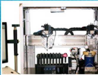
Transport des pièces par manipulateur linéaire
