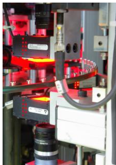
Double station verticale pour le contrôle d'aspect
