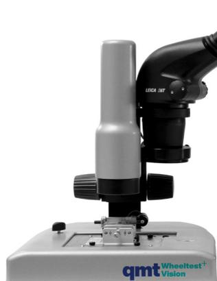
Le **qmtwheeltest-vision** permet la mise en rotation du composant avec une vitesse constante. Le système optique peut ainsi faire la mesure dynamique pour calculer les battements axiaux et radiaux ainsi que les éventuels partagements.
