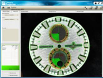
Kontrolle durch DXF Überlagerung, mit Messungen kombiniert
