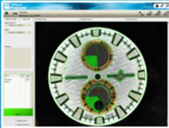
Superposition DXF et contrôle dimensionnel en simultané avec image couleur en option
