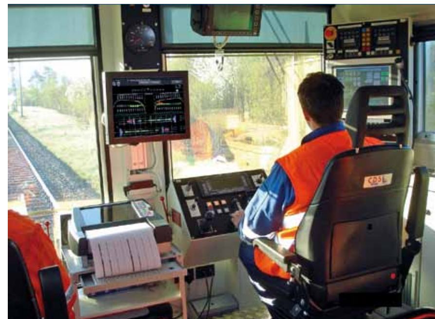
Le conducteur du train pilote les opérations de meulage en fonction des résultats relevés par le système de mesure. Sur l'écran de supervision (écran à gauche), le conducteur visualise les profils transversaux de chacun des deux rails. Le passage à des solutions de mesures sans contact s'est accompagné d'une évolution du dispositif de traitement et de visualisation des mesures embarqué dans la cabine du conducteur.
