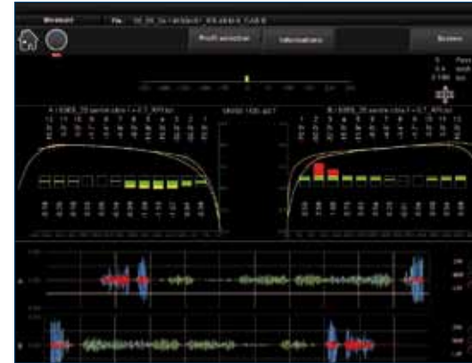
Les profils transversaux de chacun des deux rails s'affichent sur l'écran de supervision. Le profil réel est superposé aux gabarits de référence définis par l'exploitant ferroviaire. Sous chacun des points de référence, un barre-graphe indique si la côte relevée se situe dans les tolérances requises. L'acquisition et le traitement des mesures sont pris en charge par un système au format PXI.
