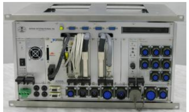
Châssis PXI spécifique pour des applications ferroviaires embarquées
