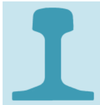
Voici la forme idéale d'un rail moderne : un champignon régulier en haut et une base épatée.
