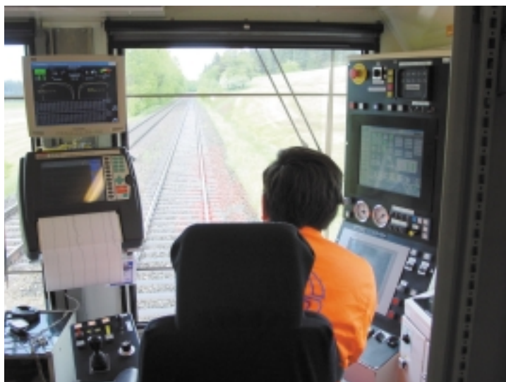
Le technicien a sous les yeux la voie ferrée, l'écran de supervision ainsi que la sortie imprimante.
