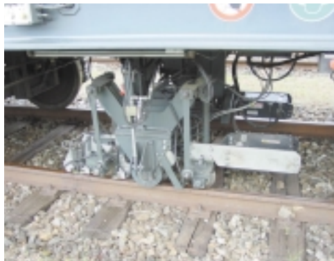
Les capteurs mécaniques sont à gauche, en contact avec le rail. À droite, la boîte noire contient un système de vision LASER qui détecte le profil transversal du rail.
