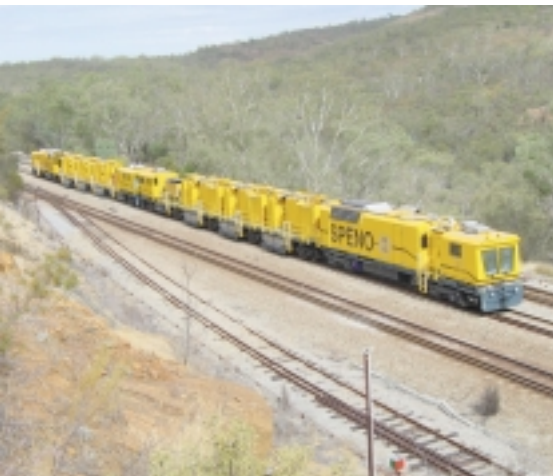
Les convois jaunes de Speno International SA sillonnent les chemins de fer du monde entier pour entretenir les rails. Ces trains embarquent un système de mesure développé par la société suisse Qualimatest.
